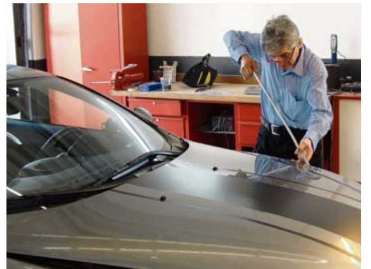
Vater Rosalbo Mennella bei der Hagelschaden-Instandsetzung mit selbstgefertigten Spezialwerkzeugen.
